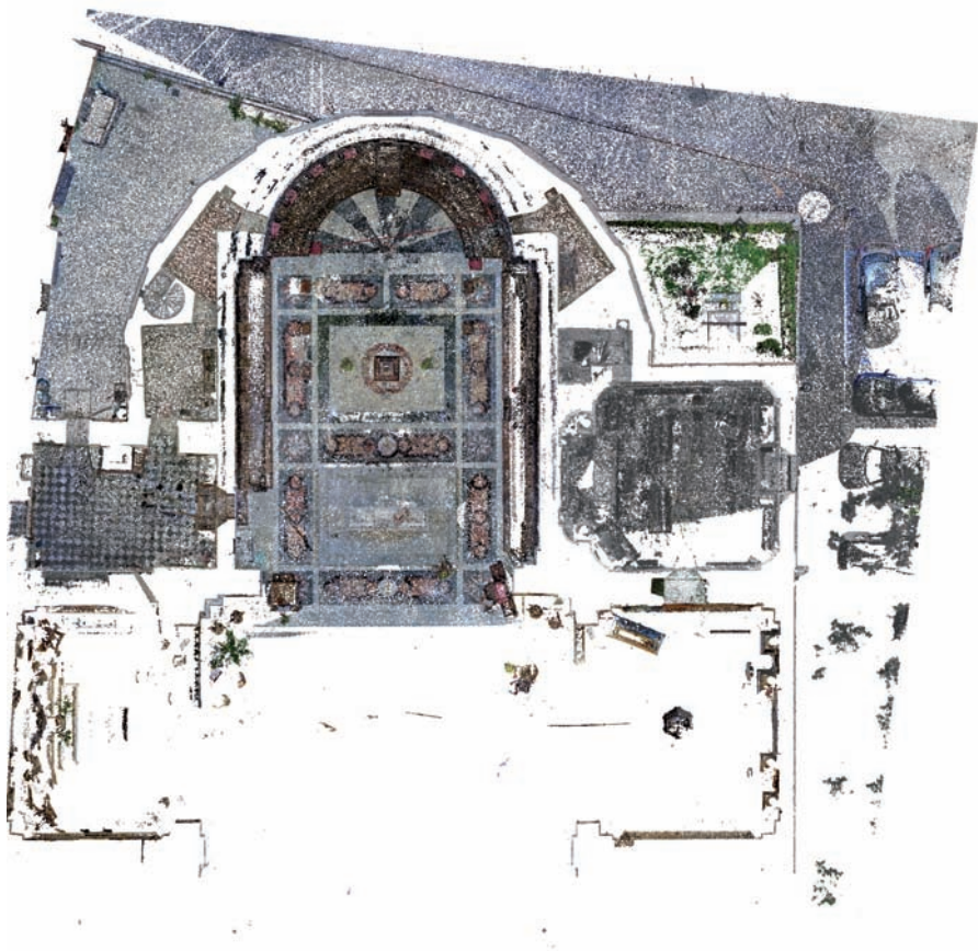
fig. 5 Sezione a livello delle cappelle radiali allo stato odierno (nuvola di punti rilevata da Giorgio Verdiani, Alexia Charalambous, Federica Corsini; rielaborazione a cura di Tommaso Sandon).
