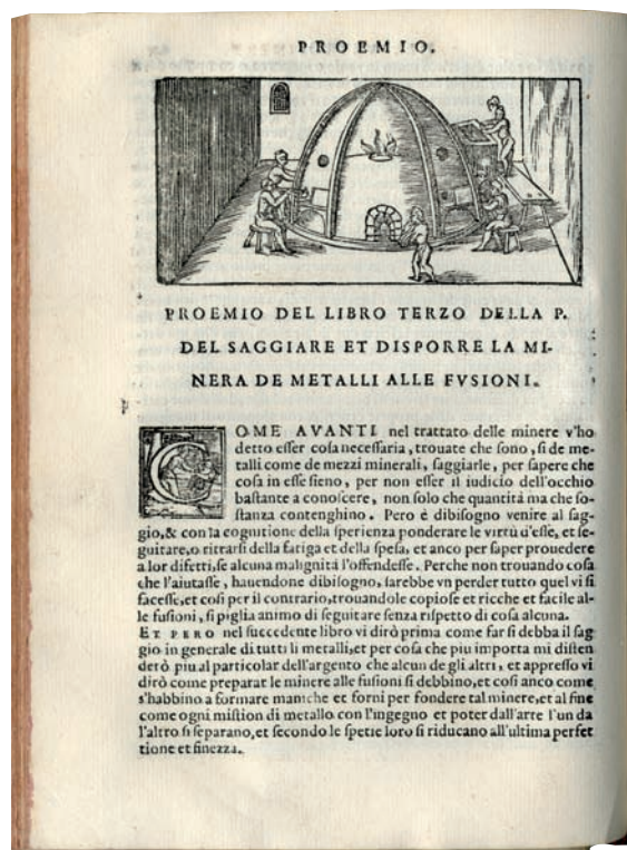
fig. 9b Fornace a cupola per lavorazione del vetro in Vannoccio Biringuccio, De la pirotecnia , 1558, xilografia, Venezia @ Biblioteca Universitaria Alessandrina di Roma.
