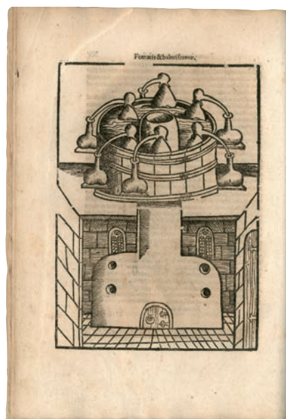
fig. 6 Fornace con bagno e flaconi detti "Testa di Moro" in Philipp Ulstadt, Coelum philosophorum , s.d., xilografia, Strasbourg @ Biblioteca Universitaria Alessandrina di Roma.
